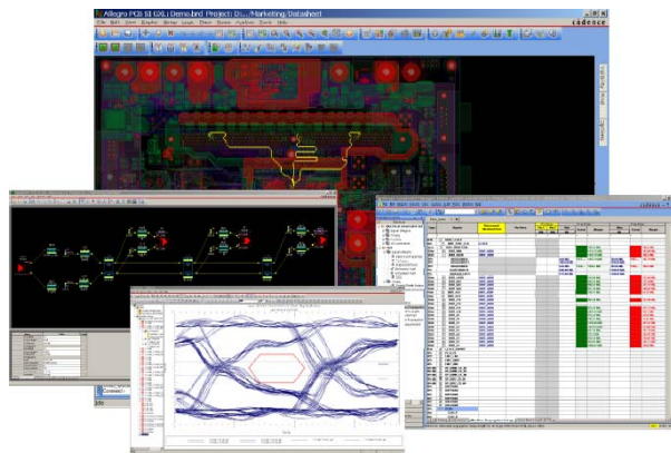
図 1: フィジカルボードから選択された信号の解析や、SigXplorerモジュールへのトポロジ抽出はデータベース変換を必要としません。解析結果は、Allegro PCB Editorによって利用されるコンストレイントマネージャーにレポートされます。カップルド・ディファレンシャルペアとディスクリート部品 (x-nets) は自動的に識別され、解析/抽出されます。
